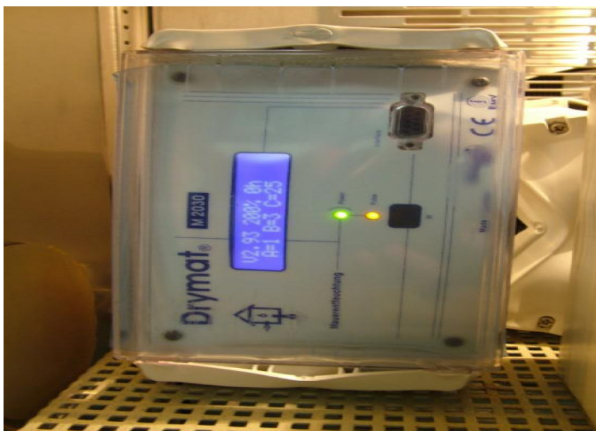
Zdjęcie 6: Test funkcjonowania po teście starzenia się, detal urządzenie 3
