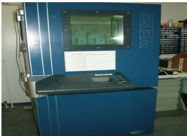
Zdjęcie 1: Szafa klimatyzacyjna WEISS SB11/160/40 z umieszczonymi w niej urządzeniami Drymat.
