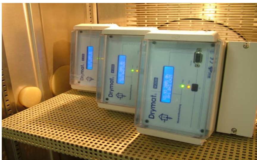
Zdjęcie 2: Test funkcjonowania urządzeń Drymat przed rozpoczęciem starzenia się.
